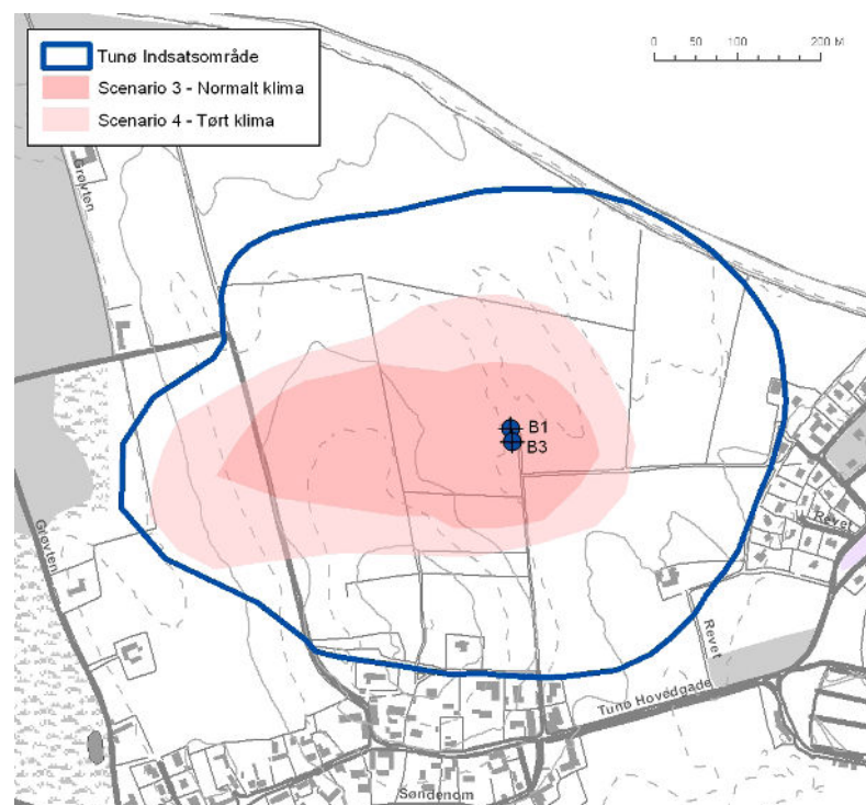
Figur 4.7 Grundvandsdannende oplande baseret på den aktuelle vandindvin- ding med inddragelse af B2 med 50 % ydelse, for aktuell nettonedbør (Scenarium 3), og i forhold til et tørt klima med 50 % nettonedbør (scenarium 4).
