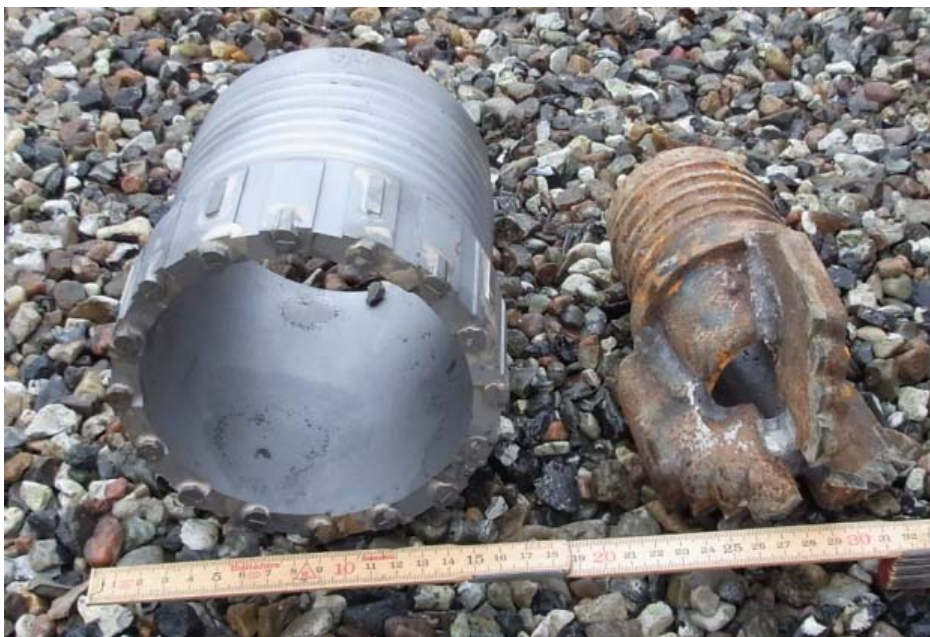
Figur 5. Eksempler på borekroner for ydre rør (til venstre) og indre rør (til højre). Borediameteren bestemmes af det ydre rør, der her er 16 cm i diameter.
